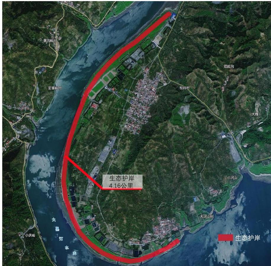
图 2.2-1 生态护岸工程总布置
