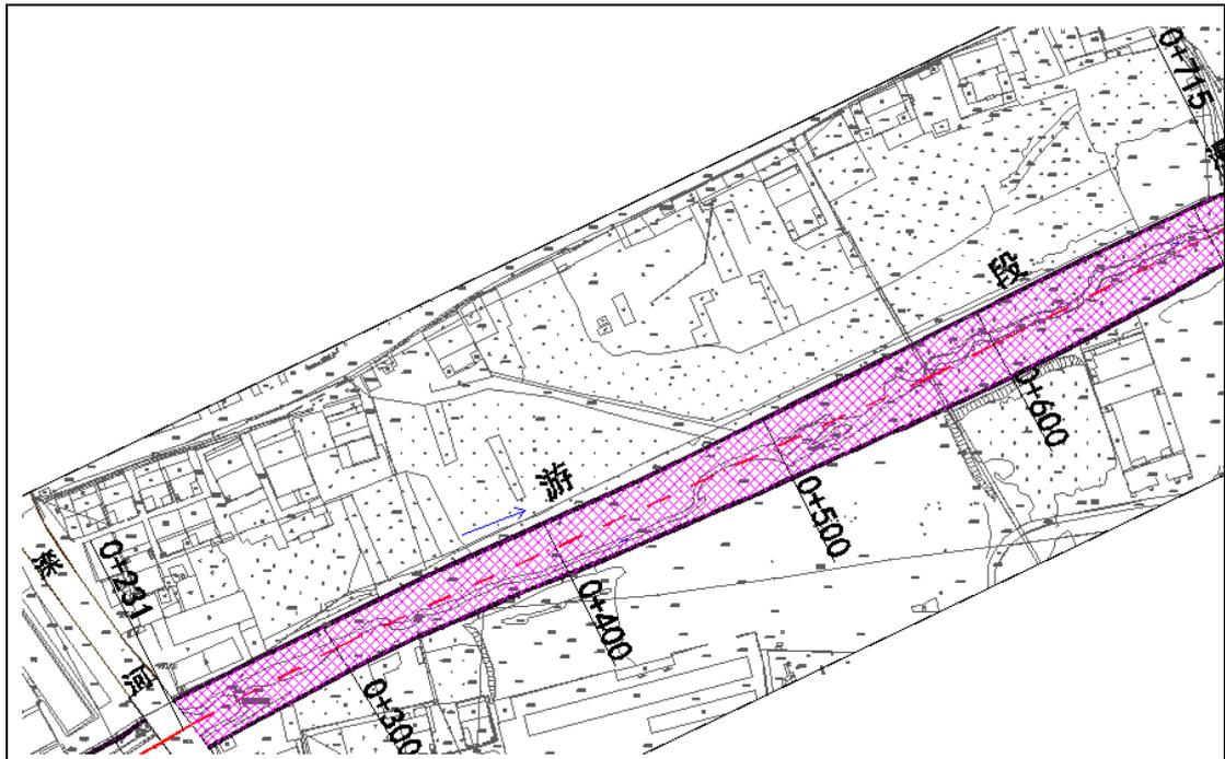
图 2.9 0+231 至 0+715 河床近自然生态系统构建平面布置图
